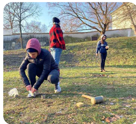
Odběr neporušeného vzorku půdy Kopeckého válečky
